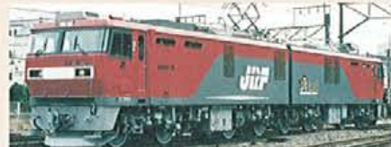
EH500形 交直流電気機関車 Class EH500 AC/DC electric locomotive
