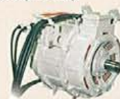
のぞみ号用主電動機 Traction motor for New Shinkansen (NOZOMI)
